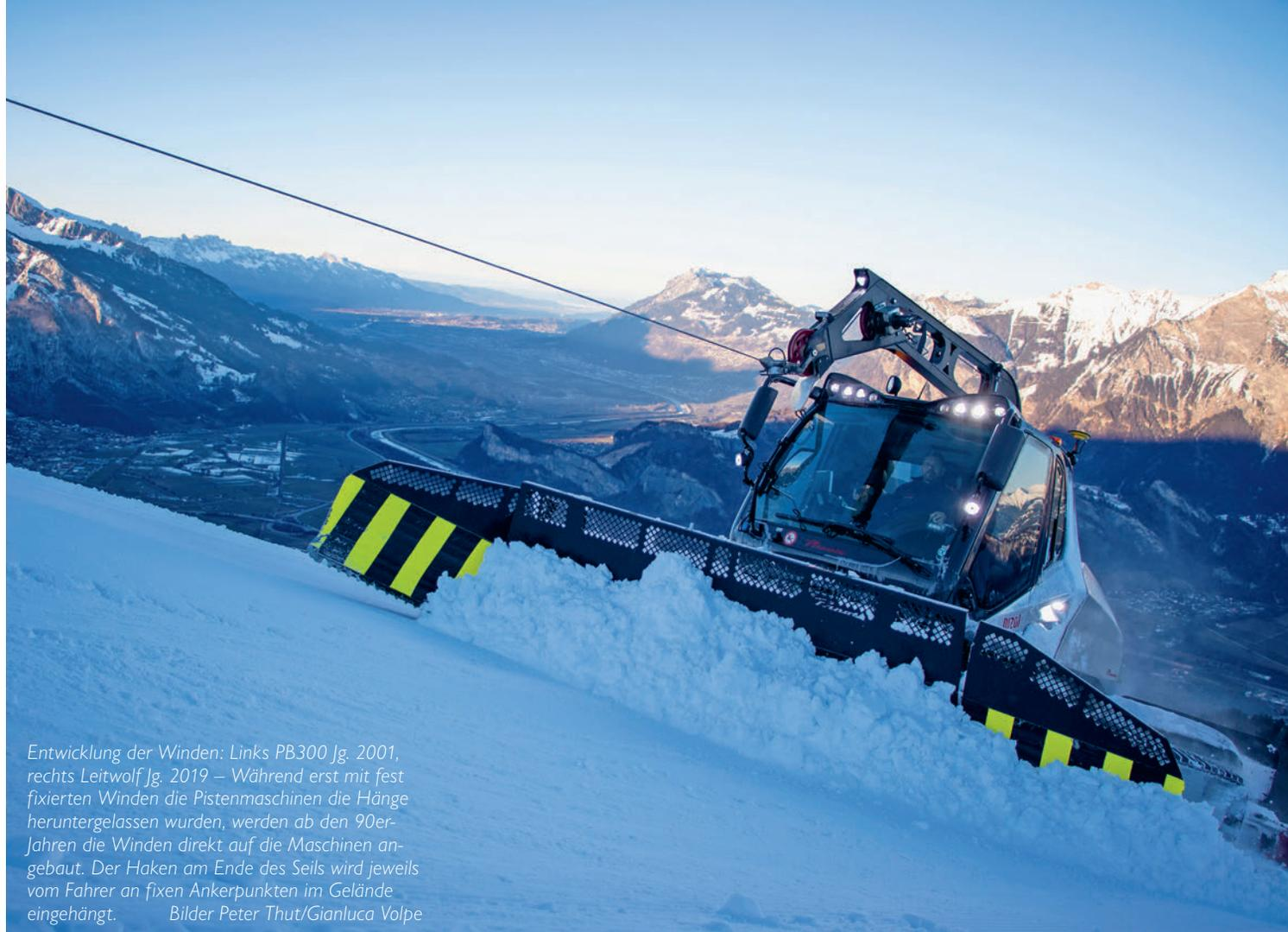
Entwicklung der Winden: Links PB300 Jg. 2001, rechts Leitwolf Jg. 2019 – Während erst mit fest fixierten Winden die Pistenmaschinen die Hänge heruntergelassen wurden, werden ab den 90er-Jahren die Winden direkt auf die Maschinen angebaut. Der Haken am Ende des Seils wird jeweils vom Fahrer an fixen Ankerpunkten im Gelände eingehängt. Bilder Peter Thut/Gianluca Volpe
